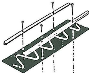
● Sinus-Flansch-Gummi und Blechleisten mit beiliegenden Schrauben, anstelle des mittleren Bodenbleches, einlegen.
