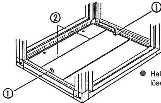
● Halterungen des mittleren Bodenbleches lösen und beides entfernen. ①
