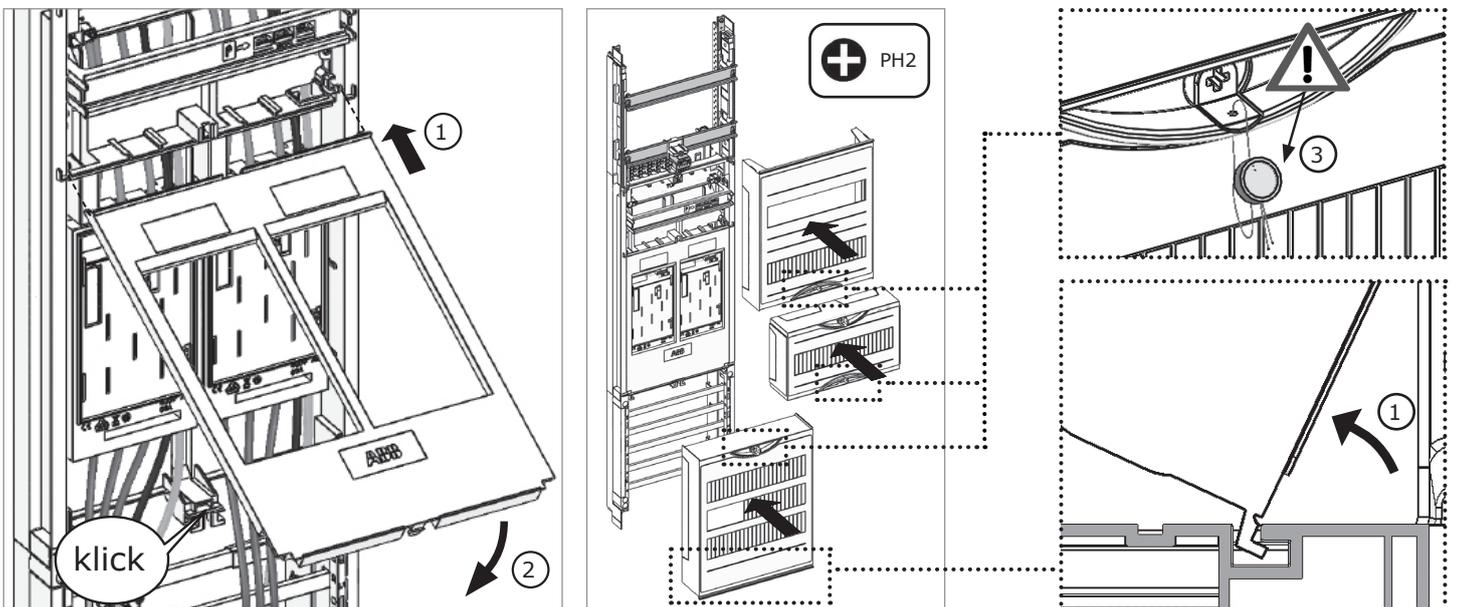
**Achtung: Schalten bzw. verschieben der Blindplatte nur in lastfreiem Zustand!**
