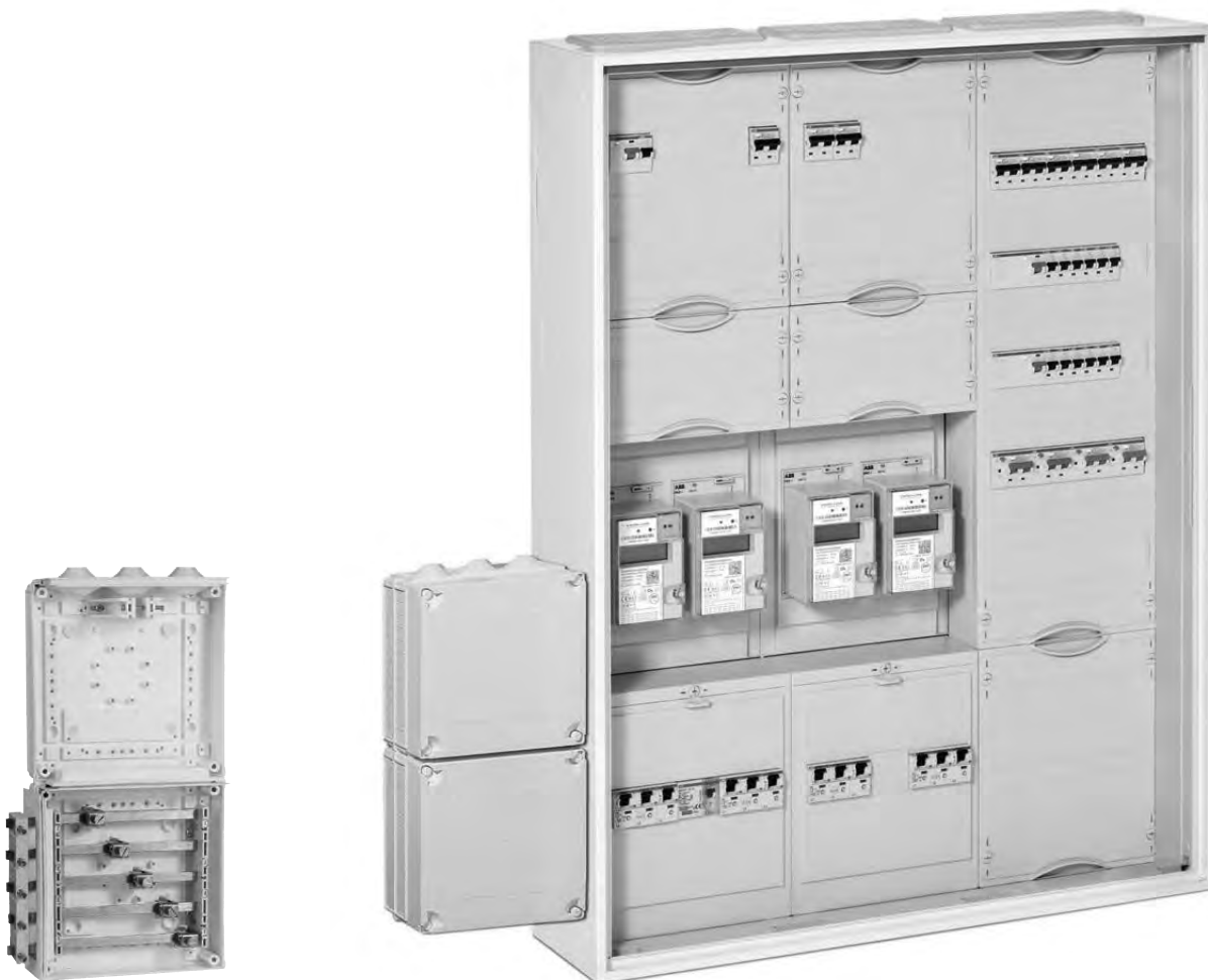
Einspeisegehäuse CZE230 mit Sammelschienensystem Cu 12 \times 5 \text{ mm} , 5-polig zur seitlichen Einspeisung rechts oder links am Zählerschrank. (Sammelschienenanschlussklemmen Zubehör)
